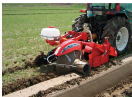
畦塗り機による畦畔管理
